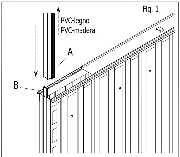
Fig. 1 - Dopo aver appoggiato il cassonetto a terra con l'accesso porta rivolto verso l'alto, prendere la guida di alluminio (A) ed inserirla nel binario (B) facendo attenzione che i profili in PVC rimangano all'esterno del cassonetto.
