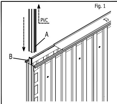
Fig. 1 - Dopo aver appoggiato il cassetto a terra con l'accesso porta rivolto verso l'alto, prendere la guida di alluminio (A) ed inserirla nel binario (B) facendo attenzione che i profili in PVC rimangano all'esterno del cassetto.
