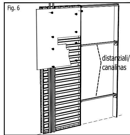
Fig. 6 - Esempio di applicazione di tubature idriche. Si ricorda che il controltelaio può ospitare al massimo n° 3 tubi idrici per ciascun lato del cassetto, in base al tipo di impianto da realizzare nell'abitazione.
