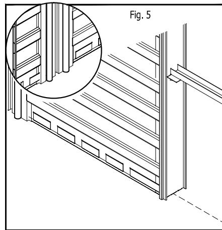
Fig. 5 - Inserimento delle tubature idriche. Il controltelaio consente la posa di max n° 03 tubi diametro 1" (compreso eventuale rivestimento).
