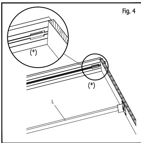
Fig. 4 - Fissare i 2 distanziatori (L) al montante in legno ed al cassetto nelle appropriate finestrelle (Fig. 4 e 5). (\*) Dettaglio della guida e dell'apertura per l'inserimento dei carrelli.
