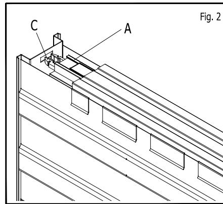
Fig. 2 - Spingere con forza la guida di alluminio (A) (vedi fig. 1) fino allo scatto di aggancio della molletta (C) sul fondo del cassetto.
