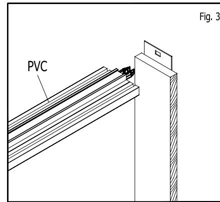
Fig. 3 - Agganciare all'altra estremità della guida in alluminio il montante di legno mediante pressione.
