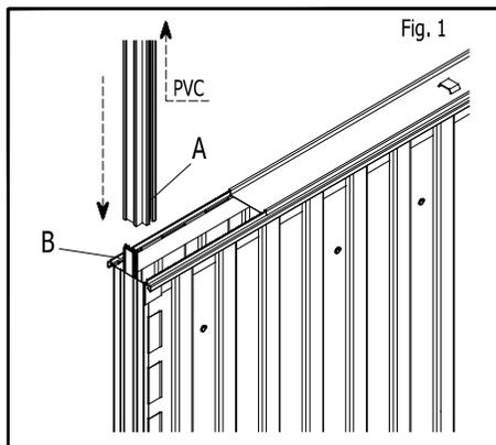
Fig. 1 - Dopo aver appoggiato il cassonetto a terra con l'accesso porta rivolto verso l'alto, prendere la guida di alluminio (A) ed inserirla nel binario (B) facendo attenzione che i profili in PVC rimangano all'esterno del cassonetto.
