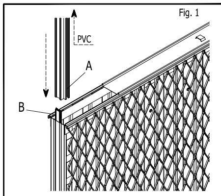
Fig. 1 - Dopo aver appoggiato il cassetto a terra con l'accesso porta rivolt verso l'alto, prendere la guida di alluminio (A) ed inserirla nel binario (B) facendo attenzione che i profili in PVC rimangano all'esterno del cassetto.
